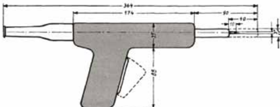
PISTOLE ALTA TENSIONE ANTINFORTUNISTICHE (disegno d'ingombro):
